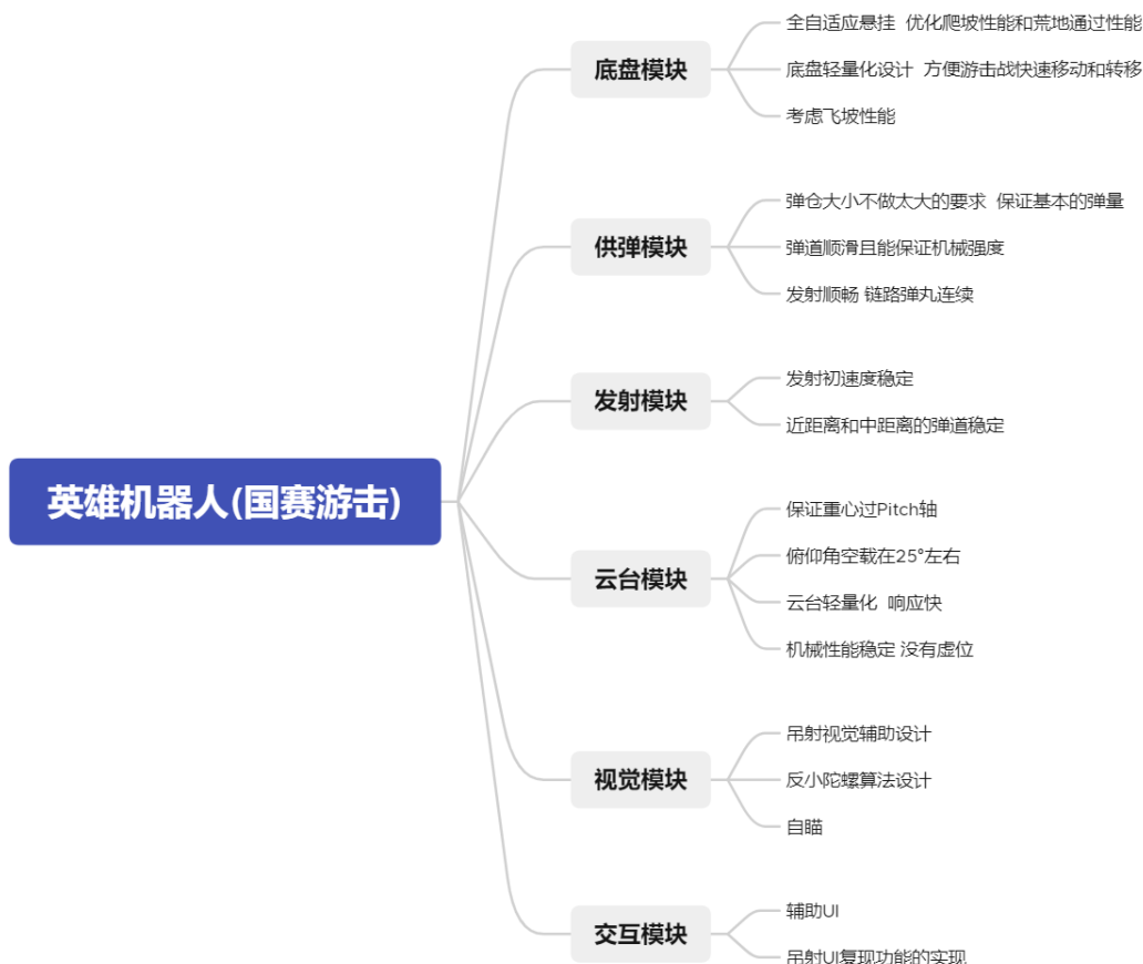
图 2-3 国赛游击英雄机器人设计思维导图
