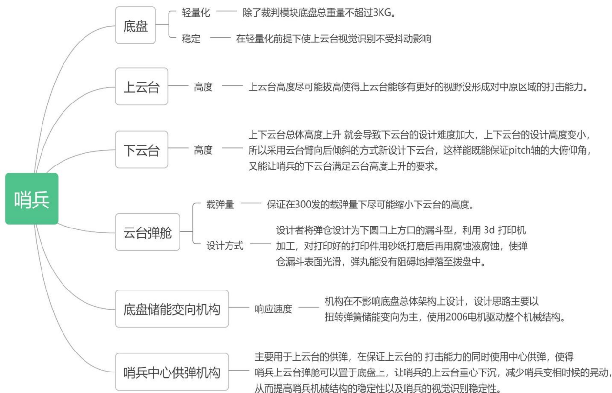
图 2-8 哨兵机器人设计思维导图
