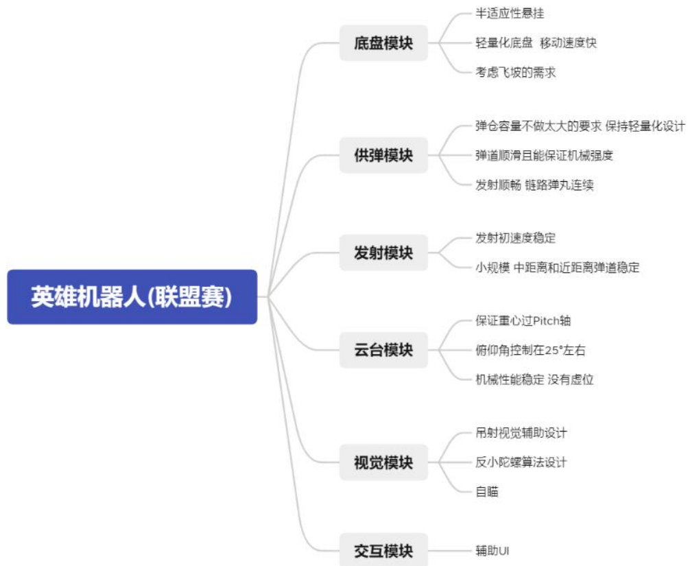
图 2-1 联盟赛英雄机器人设计思维导图
